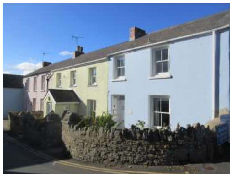
Ffigwr 15 -rendrad plaen a distemper lliw nodweddiadol
